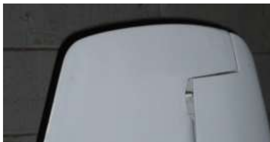
Aerodynamisk afbalancering på Ka-6Cr
