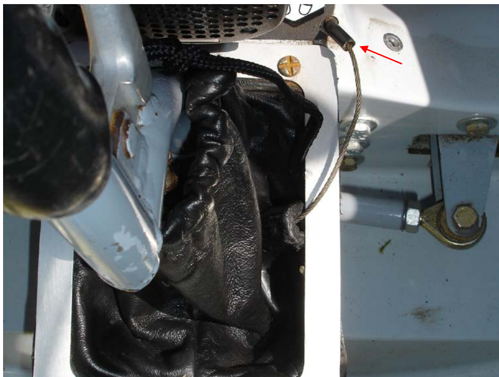
Fig. 5: Håndtaget delvist skjult i manchetten. Ved pilen ses wirestyret.
