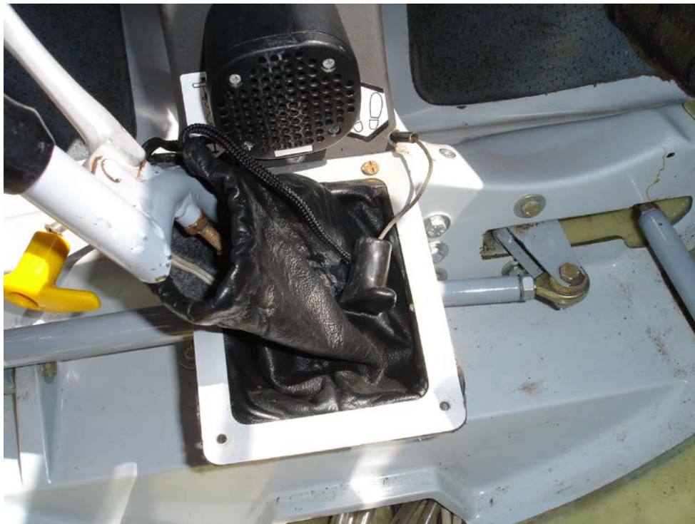
Fig. 3: Den ene side af håndtaget passer i hullet i manchetten.
