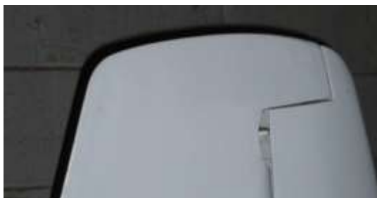
Aerodynamisk afbalancering på Ka-6Cr
